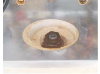
Desmontar el ánodo sacrificial
